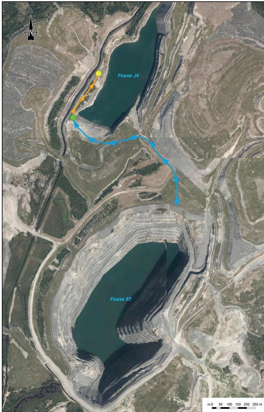
**Figure 5.2** Localisation de l'usine de traitement (point vert) et du point de rejet (point jaune) et de la conduite de refoulement à partir de la fosse 87
