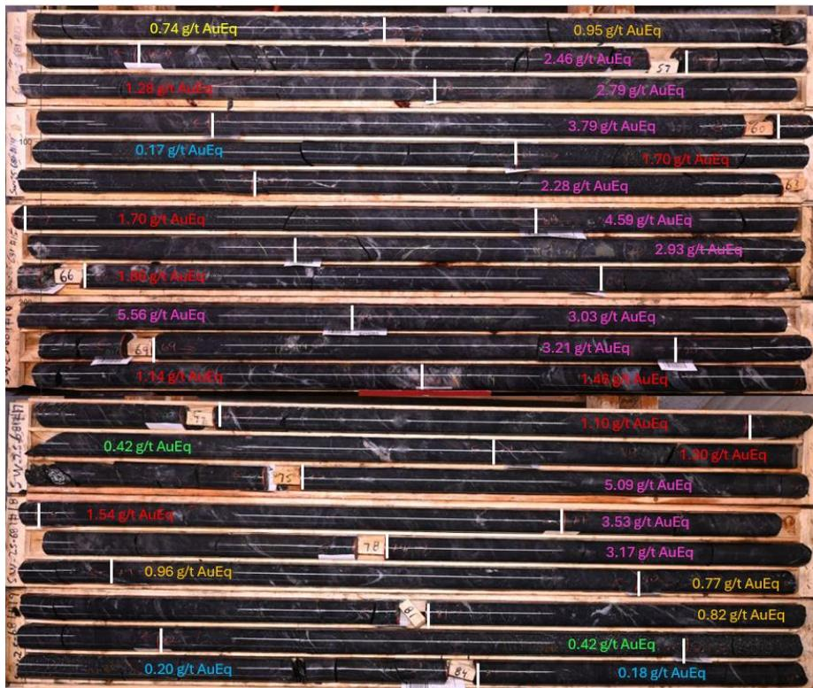
Figure 2. Photos de carottes du trou SW-25-681 de 54 m à 85 m montrant la nature continue de la minéralisation à haute teneur
