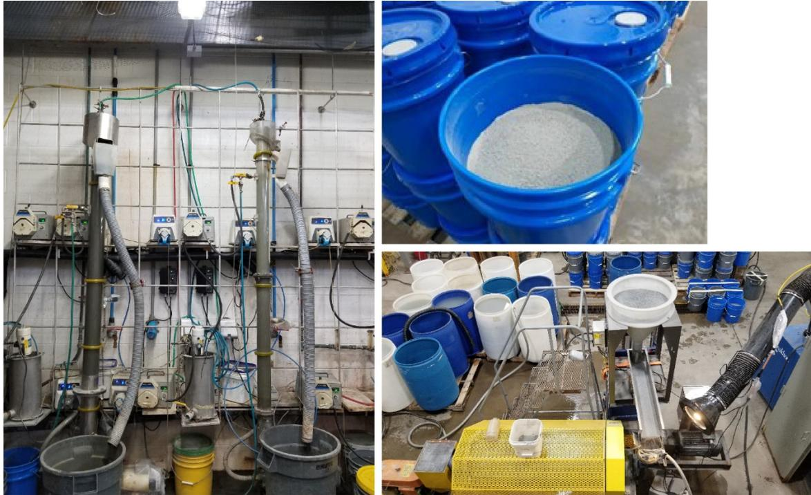
Figure 1. Échantillon de minerai homogénéisé de la zone J (en haut); flottation grossière sur colonne (à gauche); circuit de broyage en vrac (à droite).
